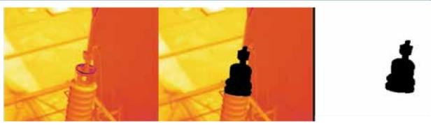
*Figura 5 – Exemplo da sequência de processamento para isolamento da região de cada objeto de interesse.*
