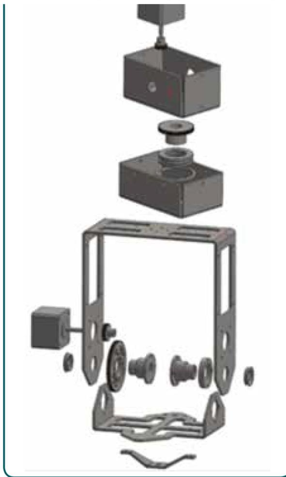
**Figura 2 – Visão explodida do suporte com movimentação para as câmeras.**
