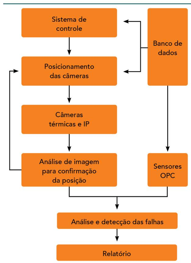
**Figura 1 – Visão geral do sistema inteligente de monitoramento.**
